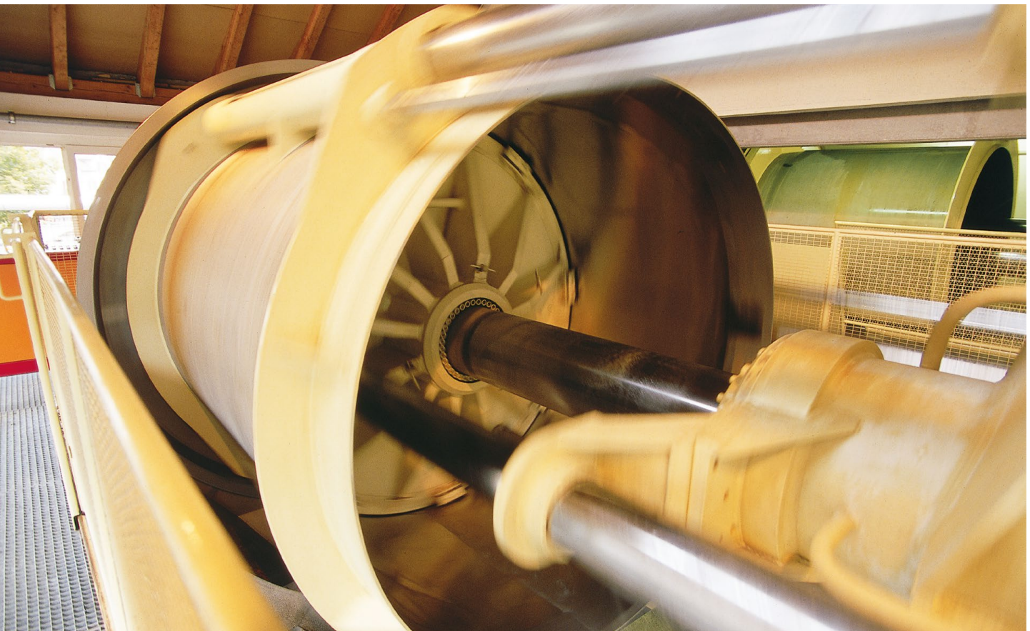
In solchen Obstpressen wird das Fruchtfleisch vom Saft getrennt. Die trockenen Überreste, auch Trester genannt, werden als Tiernahrung eingesetzt.
